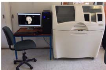
Equipo utilizado para la obtención de modelos de estereolitografía en la clínica de Prótesis Maxilofacial en la DEPEl de FO UNAM (Fig.1).
