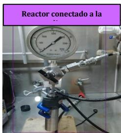
Paso 2: Abra la llave del tanque de  $O_2$  (Llave 1). Revisé el manómetro (1), para conocer la presión total del tanque. Tenga en cuenta que la presión de salida del tanque debe ser mayor a la presión de trabajo. De lo contrario se debe cambiar el tanque de  $O_2$  por uno nuevo.
