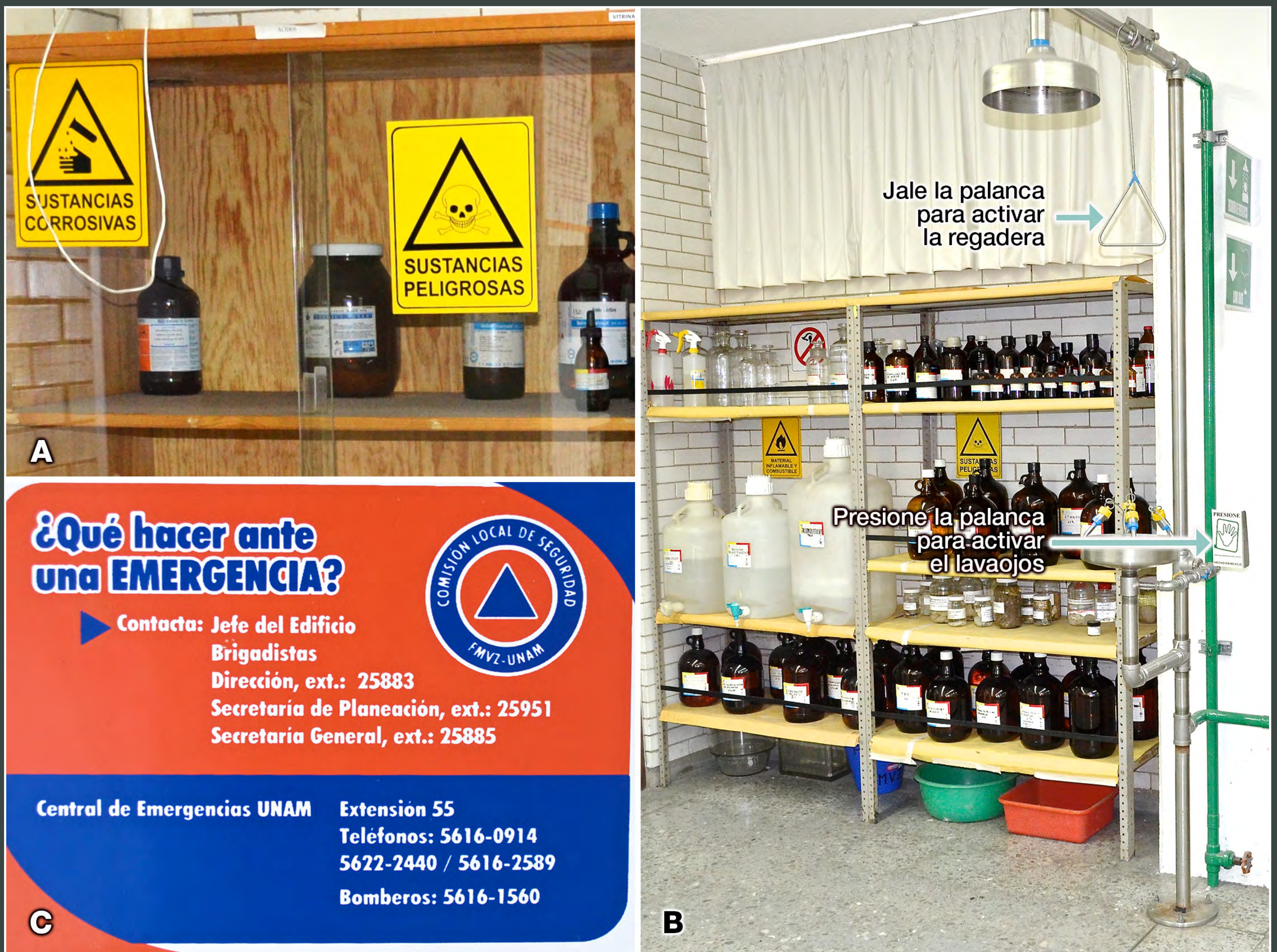
Figura 1.1. Para reducir los riesgos a la salud, en el laboratorio se han establecido normas de seguridad e higiene. A) Almacén de sustancias peligrosas. B) Regadera y lavajos para utilizarse en caso de salpicaduras con sustancias peligrosas. C) Teléfonos de emergencia.
