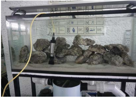
Figura 3.1.1 Medición de oxígeno disuelto FUENTE: MVZ. Ma. de la Luz Chavacán Avila
