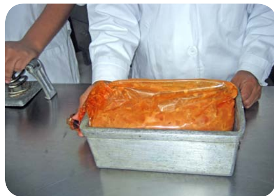
Figura 4.4. Vaciado de la pasta en bolsa y depositado posteriormente en un molde. Fuente: Miguel Ángel Martínez Castillo
