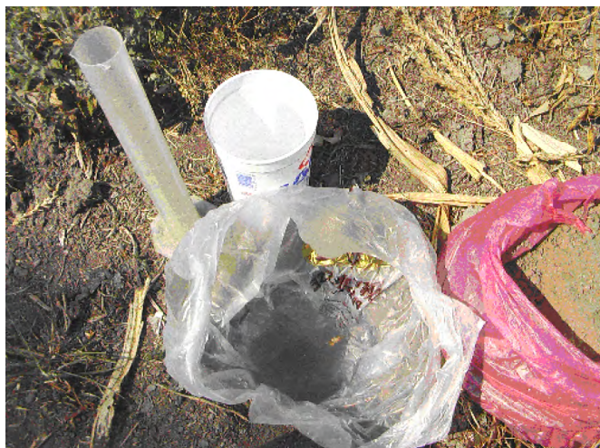
Medición del volumen del hoyo para medir la densidad aparente del suelo
