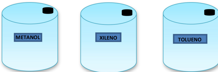
Figura 5.4. Contenedores para acumular RPQ.
