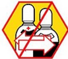
7. Queda prohibido terminantemente efectuar trasvases de los gases. El llenado sólo puede realizarlo el proveedor.
