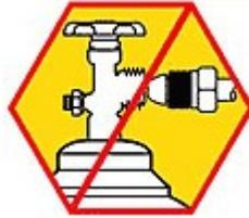
6. Está prohibida la sustitución de un gas de cualquier tipo por otro.
