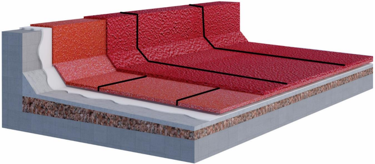
Figura 6 Pretil perimetral cubierto con impermeabilizante y pendiente sobre el soporte base
