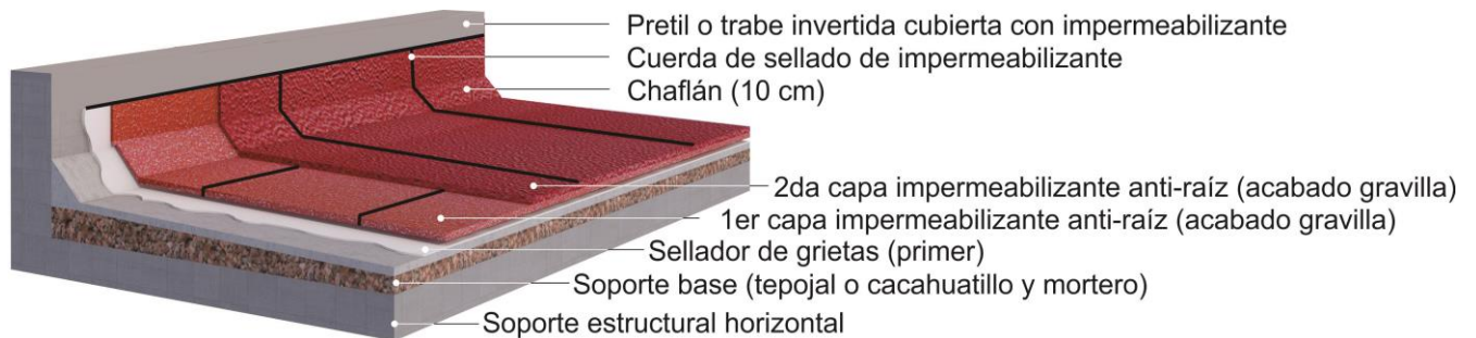
Figura 3 Elemento emergente cubierto totalmente con membrana anti-raíz
